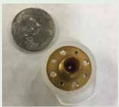
A 220-330 GHz horn antenna!
